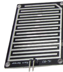
Gambar 9.57 Modul Sensor Hujan
