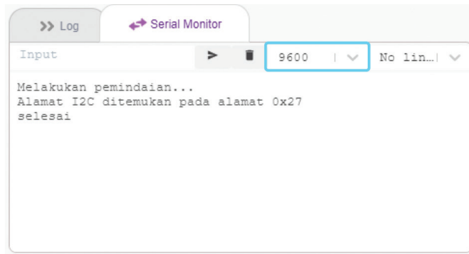
Gambar 9.43 Melihat alamat I2C pada Serial Monitor
