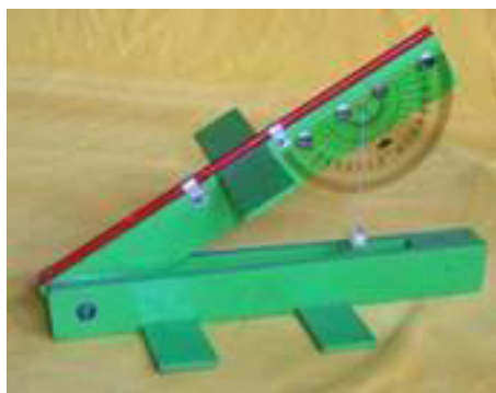
Gambar 41. Klinometer yaitu alat untuk mengukur sudut elevasi (Ahmad Sultoni/Jurnal Prosiding Seminar Nasional Matematika)
